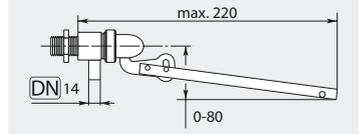
3/8" M. Laiton. Max. 10 bar / 85 °C
