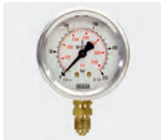
∅ 63 mm. 1/4" M. Boîtier inox. Entrée verticale. Type WIKA
