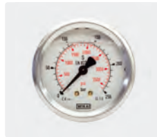
∅ 63 mm. 1/4" M. Boîtier inox. Entrée latérale. Type WIKA
